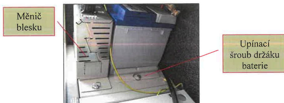
Obr. 71 Provedení upínacích šroubů krytů pro montáž baterie a měniče blesku
