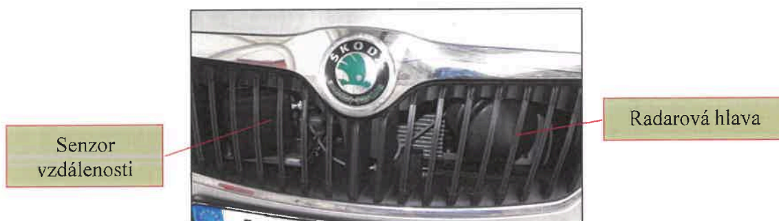
Obr. 23 Ukázka zástavby senzoru vzdálenosti a radarové hlavy za maskou vozidla
