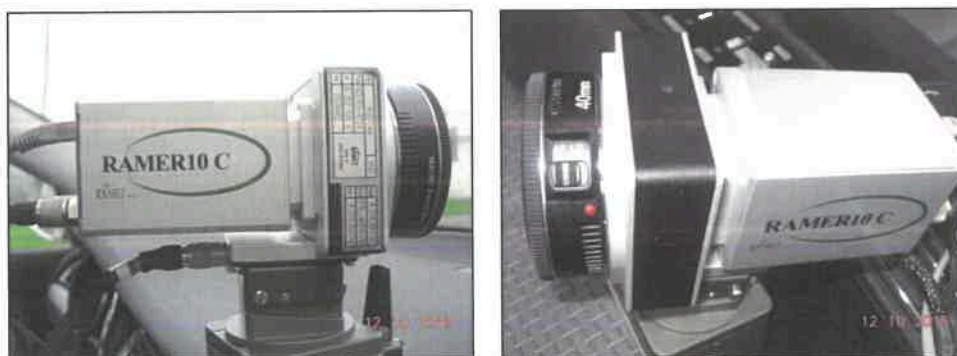
Obr. 14 Digitální kamera GigE s objektivem s pevným ohniskem „miniVOSA“ (ilustrační foto)
